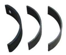
DRUM BRAKE LININGS FOR TRAMWAYS AND LIGHT RAIL VEHICLES
